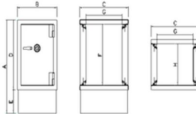
Esta caja tiene acceso por dos caras, permite ingreso de valores por un lado, retiro por el otro y viceversa. No permite tener ambas puertas abiertas a la vez (opera en modo esclusa), evitando que exista contacto entre ambos lados.
